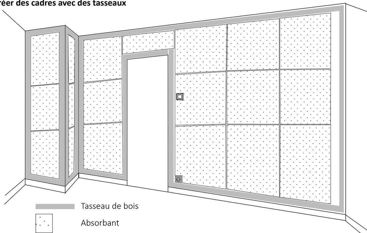
**2. Les éléments électriques** doivent être déplacés pour arriver à fleur de la surface du tissu tendu.
